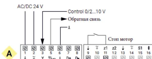
Дверной переключатель VRU-M1R может быть оснащен командой «Стоп мотор» для предотвращения перемещения привода заслонки в конечное положение при открытии двери.
