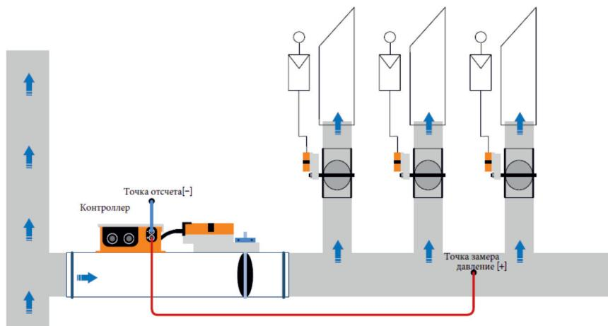
Контроль давления в воздуховоде с помощью VRU-D3-BAC (чистый воздух) и VRU-M1-BAC (загрязненный воздух).
