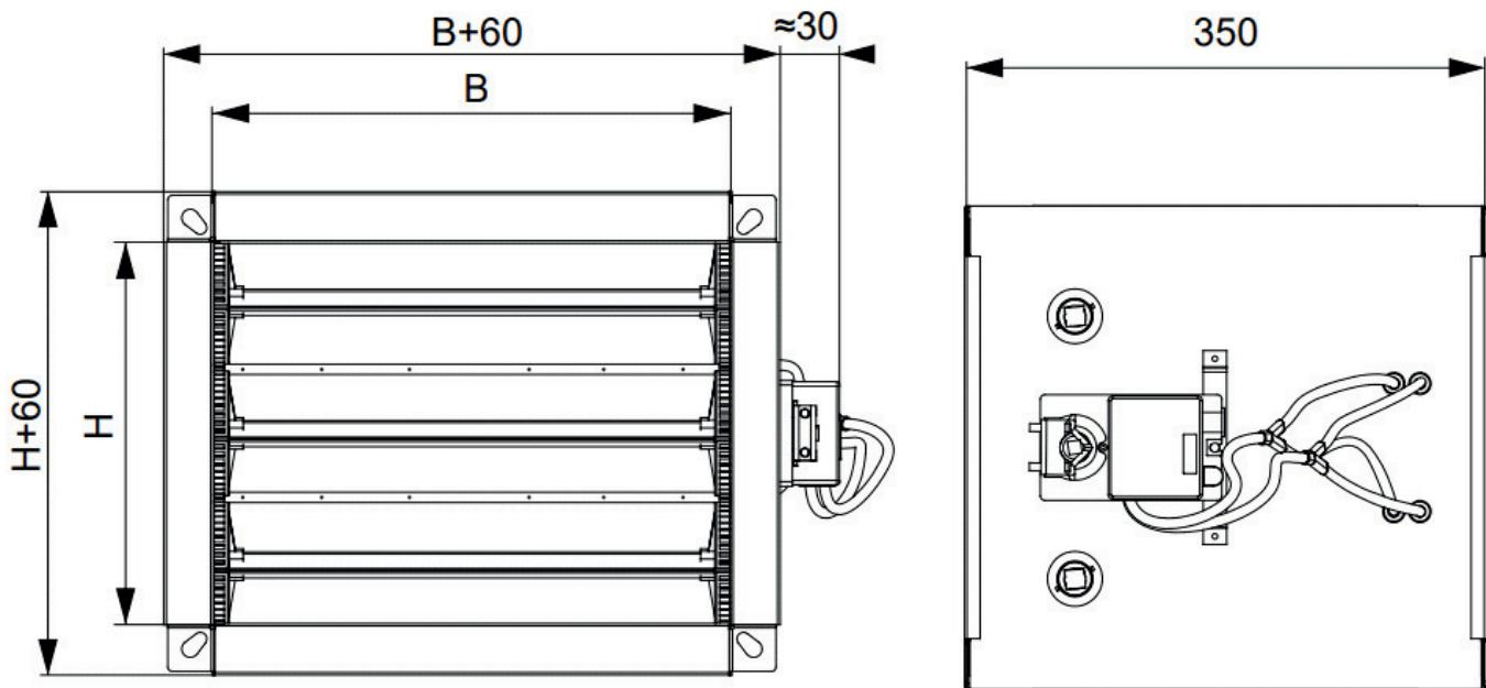
Исполнение в шумоизолированном корпусе: Исп.2
